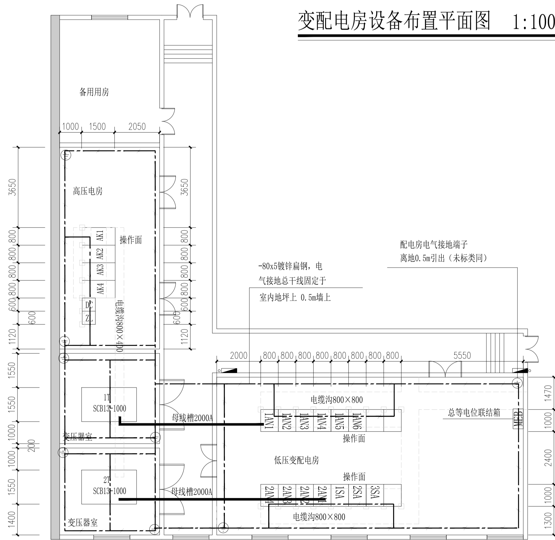
变配电房接地平面图 1:100
